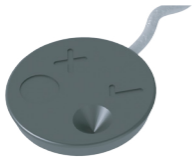
Figura 1: Rastreador Eletromagnético do Paciente – 10 utilizações
