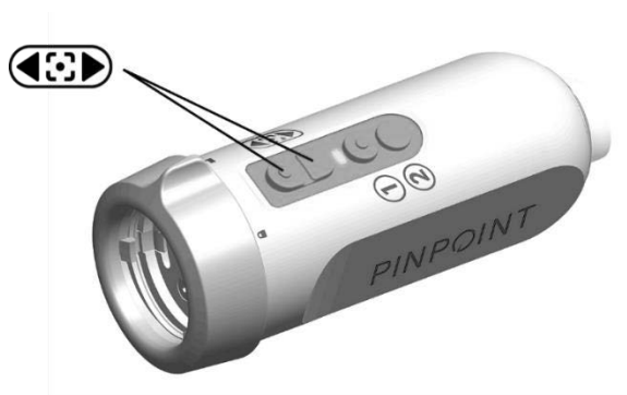
Figure 19 : Boutons de réglage de la mise au point
