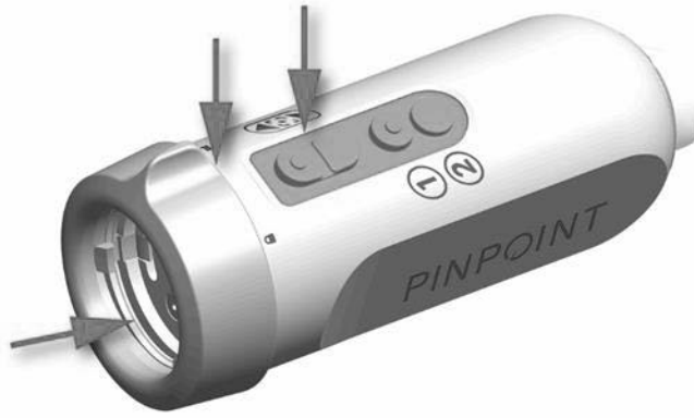
Şekil 56: PINPOINT kamera üzerindeki ulaşılmaz zor alanlar
