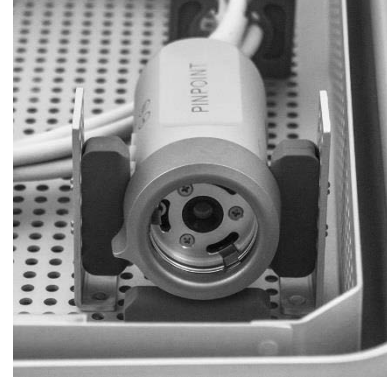
Şekil 60: PINPOINT kameranın ve konektörün sabitlenmesi
