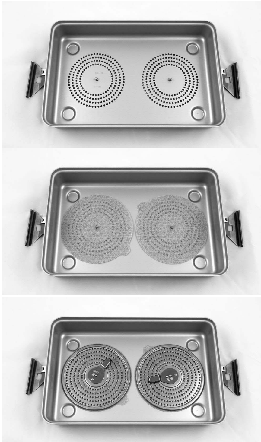
Figur 57: Installere filtre i bunnen av steriliseringsbrettet
