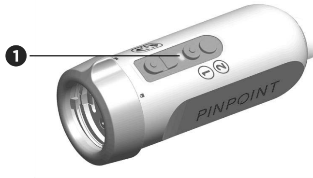
Abbildung 22: Anzeigeleuchte „Laser ein“ im Fluoreszenz-Bildgebungsmodus
