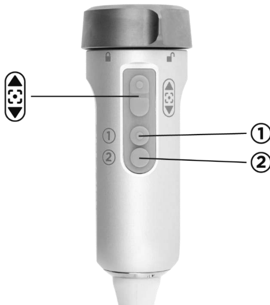
Rys. 12: Przyciski służące do sterowania podstawowymi funkcjami kamery PINPOINT (widok z góry)
