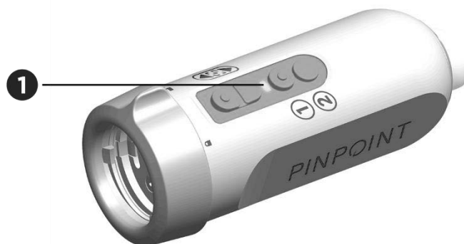
Figura 22. Indicador de “láser encendido” (laser-on) en el modo de obtención de imágenes de fluorescencia
