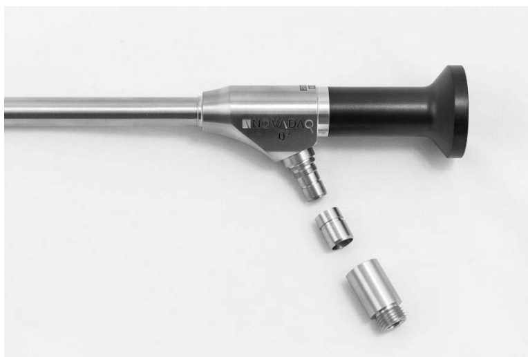
Abbildung 48: Abnehmen der Adapter vom Laparoskop
