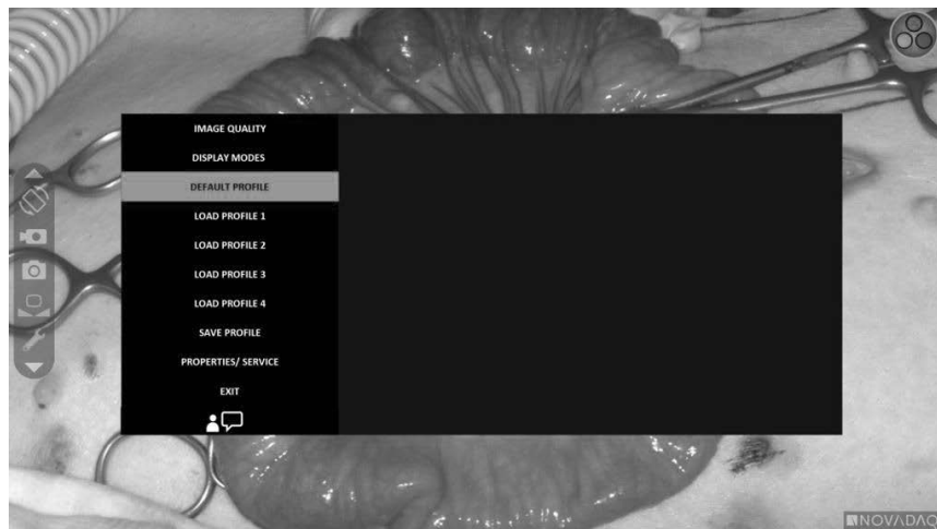
Figura 46. Pantalla de visualización que muestra el menú de opciones de VPI superpuesto en la imagen de vídeo
