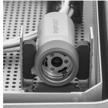
Figur 60: Fastgøring af PINPOINT-kameraet og konnektoren
