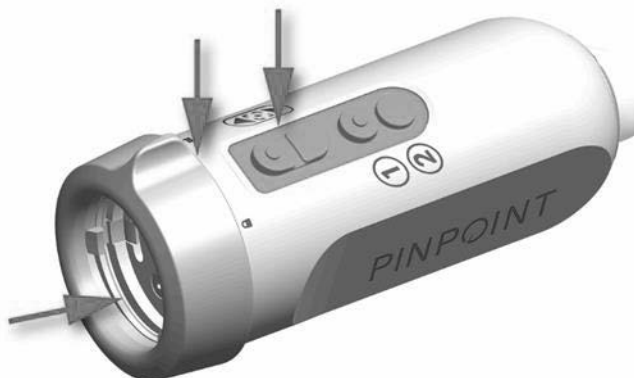
Kuva 56: Vaikeasti puhdistettavat alueet PINPOINT-kamerassa
