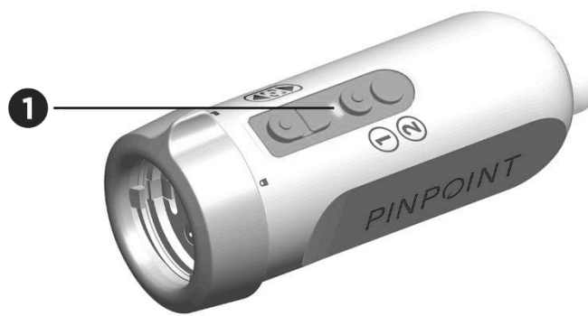
Figura 22: Indicador de laser ligado no modo de imagiologia de fluorescência
