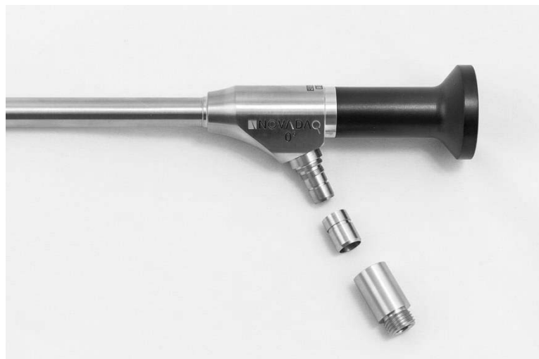
Figura 49: Remover os adaptadores do cabo guia de luz
